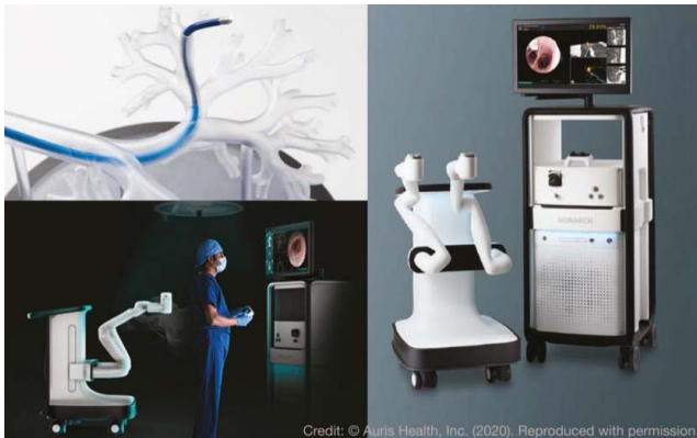
Рис. 4. Платформа MonaSCh. Для управления системой электромагнитной навигации используется ручной контроллер. Телескопическая конструкция, включает прицел, который состоит из роботизированного внешнего тубуса (наружный диаметр 5,7 мм) и внутреннего бронхоскопа (диаметр 4,4 мм) со встроенной камерой, аспирацией и ирригацией на его гибком наконечнике, изгибающемся до 180° [10,15].
