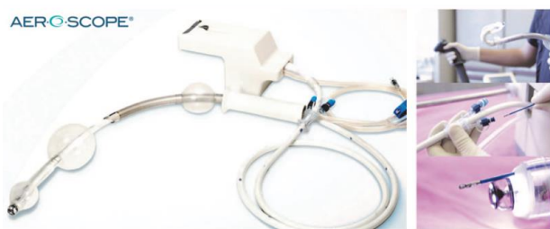
Рис. 7. Роботизированная одноразовая колоноскопическая система Aer-O-Scope имеет пневматический самодвижущийся механизм, управляемый с помощью рабочей станции на базе персонального компьютера и джойстикового управления [30].
