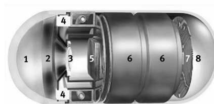
Рис. 4: Видеокапсула PillCam в разрезе
