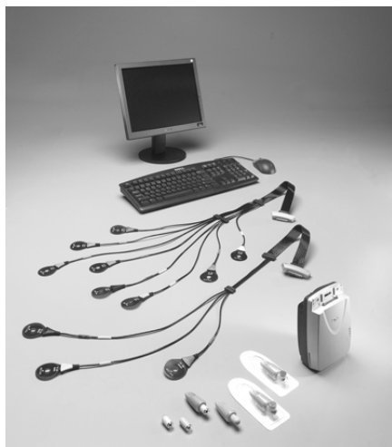
Рис. 3: Набор аппаратуры Given Imaging для видеокапсульной эндоскопии
