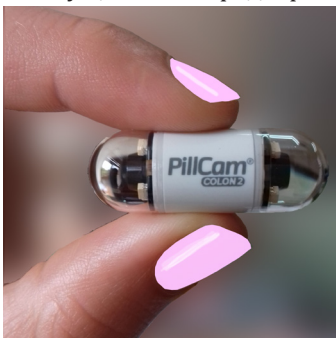
Рис. 1. Видеокапсула PillCam Colon2 для исследования толстой кишки
