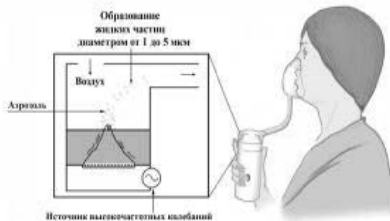
Рис. 2. Схема ультразвукового небулайзера (O'Callaghan & Barry).
