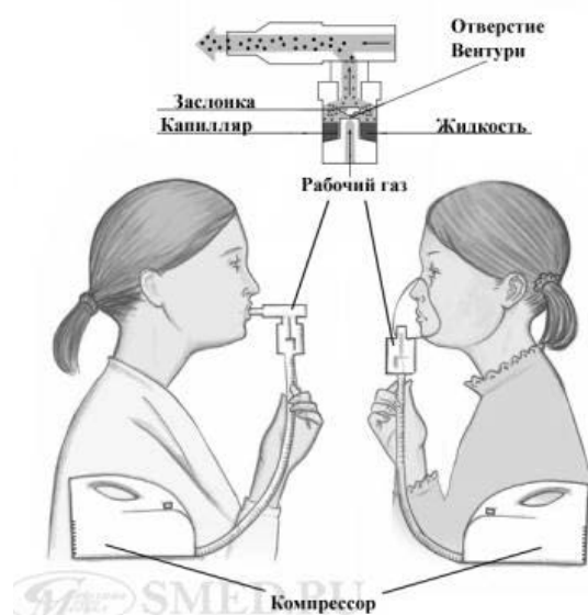
Рис. 1. Схема струйного небулайзера (O'Callaghan & Barry).
